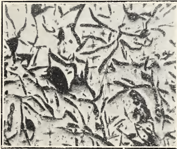
Fig. 34—Gray cast iron. \times 100 .
